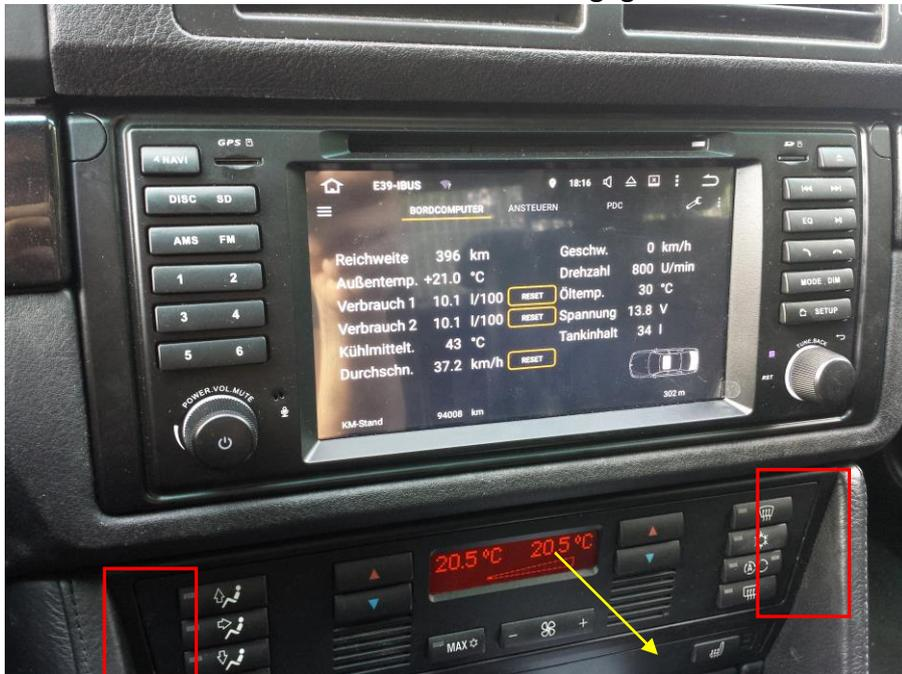
Das Klimabedienteil wird rechts und links durch den Rahmen gehalten (Haltepunkte sind rot eingerahmt). Durch gleichmäßiges Gegendrücken auf beiden Seiten kommt es entgegen.
