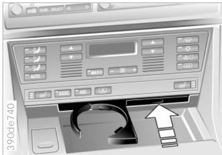
Zwei Halter für Getränkedosen befinden sich vorn in der Mittelkonsole (Bild). Zum Öffnen antippen, zum Schließen zurückschwenken.
