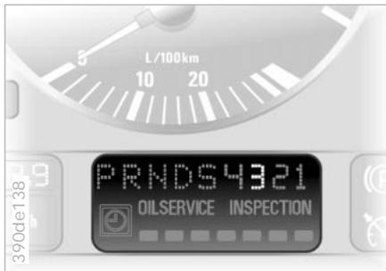
Sie können wie mit einem normalen Automatic-Getriebe fahren, zusätzlich aber auch manuell schalten.
