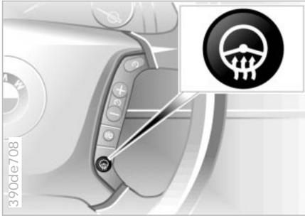
Die Lenkradheizung funktioniert in Zündschlüsselstellung 2.
