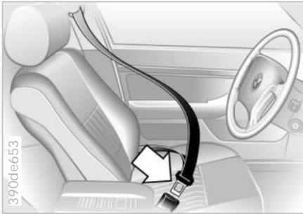
▷ Im Fond ist das mit der Aufschrift „CENTER“ gekennzeichnete Gurtschloss ausschließlich für den mittleren Insassen vorgesehen.
