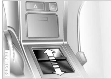
Der Deckel des Fachs vorn an der Schrägseite der Mittelkonsole kann auf- und zugeschoben werden (Pfeil). Bei Ausstattung mit Cassettenhalterung\* öffnen Sie jedes Cassettenfach durch Drücken der kleinen Taste.
