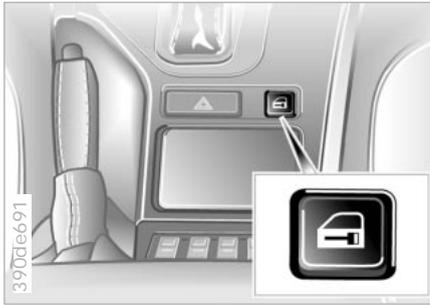
Mit dieser Taste betätigen Sie bei geschlossenen Vordertüren die Zentralverriegelung. Damit werden Türen, Heckklappe und -scheibe sowie Tankklappe nur entriegelt bzw. verriegelt, nicht aber diebstahlgesichert.
