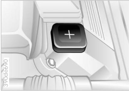
5. Mit dem Starthilfekabel (+) eine Verbindung zwischen dem Pluspol der Batterie im anderen Fahrzeug und dem Fremdstartstützpunkt im Motorraum des BMW herstellen. Die Abdeckkappe des BMW Fremdstartstützpunkts ist mit „+“ markiert, siehe Bild. Zum Öffnen die Kappe aufklappen
