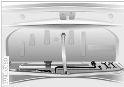
Das Bordwerkzeug ist in der Heckklappe untergebracht.
