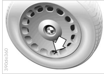
▶ Verwenden Sie für dieses Leichtbaurad nur die werkseitig verbaute Radvollblende, sonst ist nicht gewährleistet, dass die Blende fest sitzt. ◀
