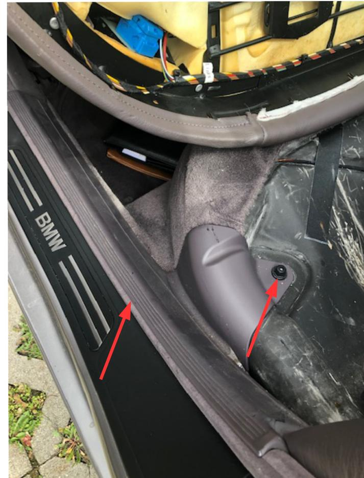
Es gibt 2 Möglichkeiten. Die 1. ist einfach. Unter dem Skisack hindurch in den Kofferraum und dort seitlich unter der Verkleidung verschwinden lassen.
