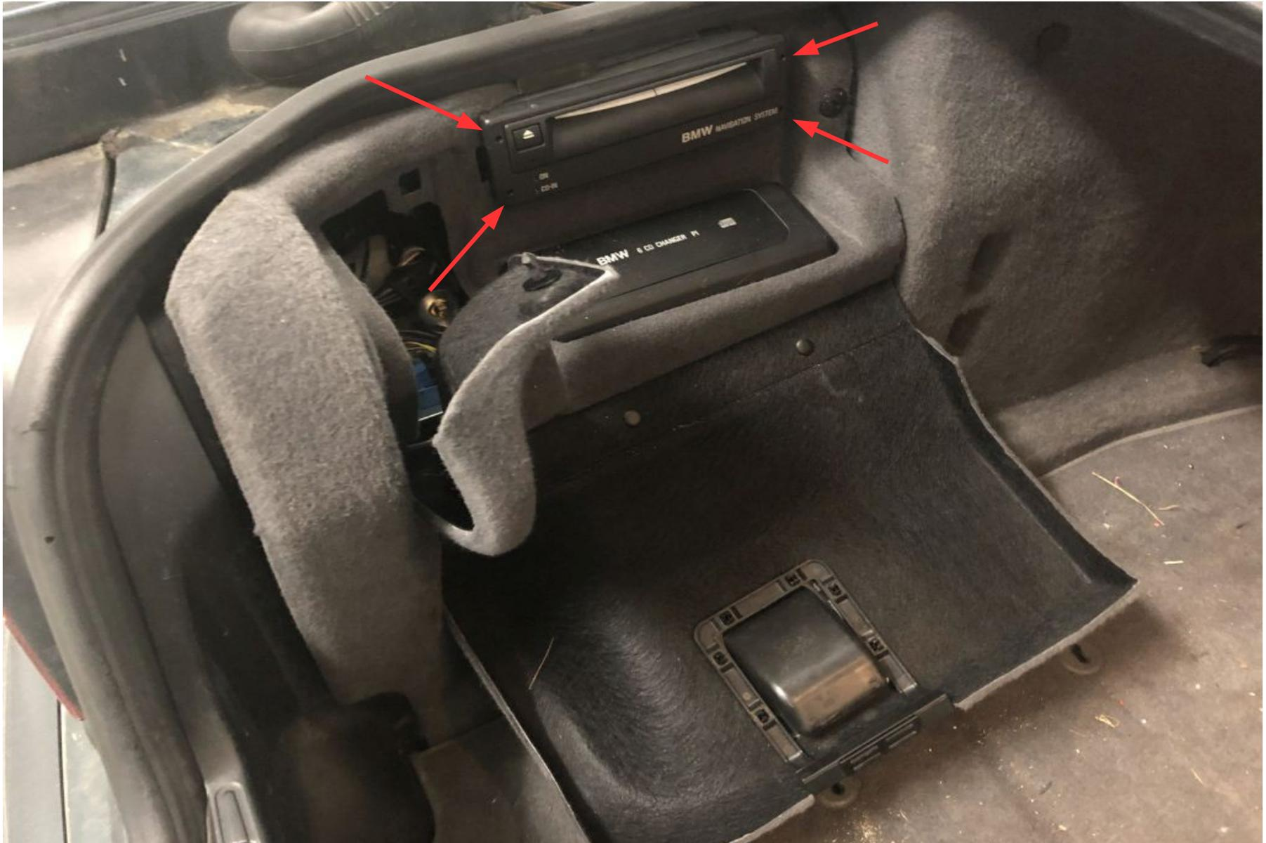
Nachdem die Verkleidung abgebaut ist, hat man jetzt mal einen Blick auf die verbauten Komponenten. Im Prinzip ist es ganz einfach, es muss alles raus. Das einzige was wir dann benötigen ist der DSP Verstärker falls einer vorhanden ist. CD Wechsler würde ich auch wieder einbauen da sonst ein Loch in der grauen Seitenverkleidung nach dem Zusammenbau zu sehen ist. Ein wenig schauen und alle Schrauben lösen. Bis dann das Radiomodul freigelegt ist. (siehe nächste Seite)
