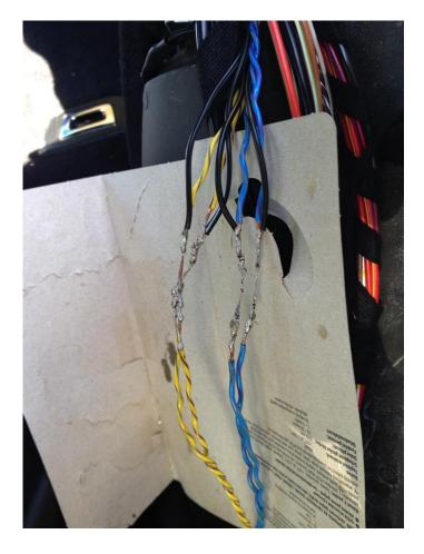
Das Lötergebnis bietet sicherlich Verbesserungspotenzial aber es geht recht eng zu, da die Kabel am Einstieg gerade nach unten laufen und somit kaum Platz ist zum anheben. Deshalb habe ich mit den Adern des Cinchkabels die Länge etwas überbrückt. Eine zweite Person erleichtert das Löten hier sicherlich.
