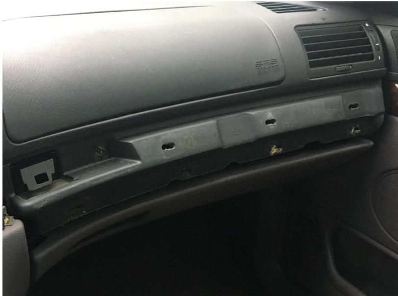
8. Nun sollte alles frei gelegt sein um den Rahmen zu lösen und ihn zu entfernen. Auf beiden Seiten des Rahmens jeweils die beiden Schrauben entfernen wie auf dem Bild zu sehen. Die kurze Holzeleiste rechts vom Lenkrad einfach vorsichtig rausziehen mit beiden Händen. Ist nur eingesteckt und die dahinterliegenden beiden Schrauben entfernen. Gibt etwas mehr Luft beim aus und einbauen des Rahmens.
