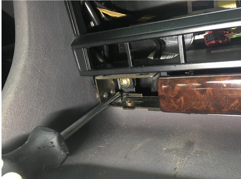
7. Handschuhfach öffnen und Unterseitig die Plastikabdeckung mit der Beleuchtung durch 3 weitere Kreuzschlitzschrauben lösen, damit man dann nach oben reingreifen kann und die Plastik und Holzleiste lösen kann. Man kann sie erfühlen. Sind lange weisse Kunststoffmuttern. So die Bezeichnung bei BMW. Im ETK sind sie unter folgender Nummer zu finden.: 51458165253
