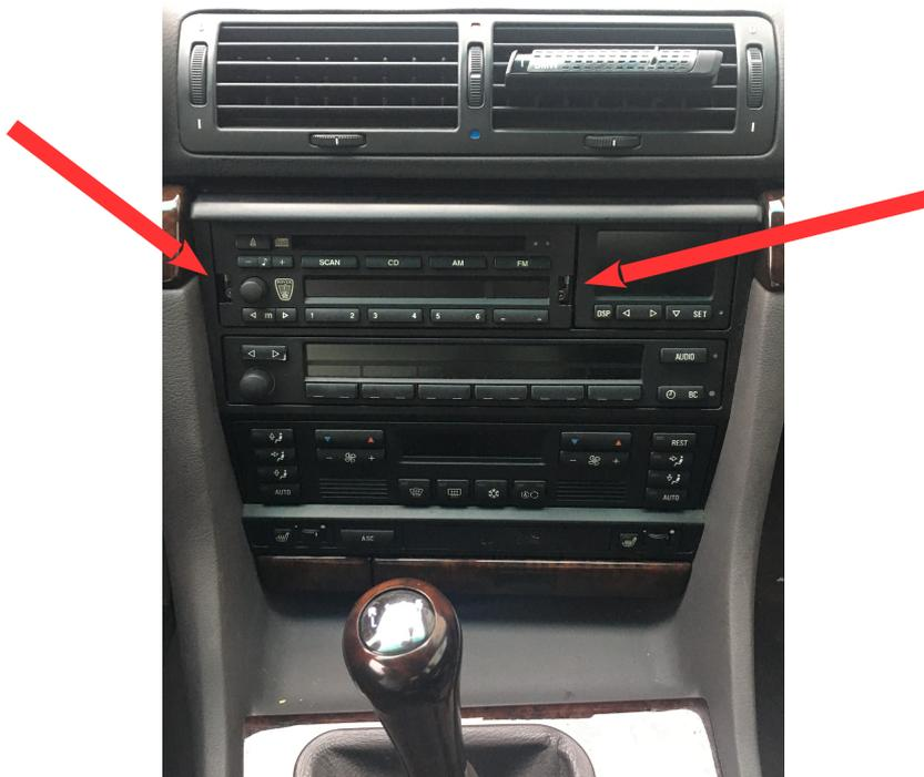
2. Vom nun leeren Radioschacht kann man dann mit etwas Druck von hinten den DSP Bildschirm oder Münzfach auch rausdrücken.
