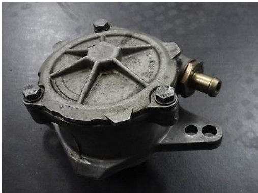
Abbildung 43: VFL Vakuumpumpe OHNE Rückschlagventil
