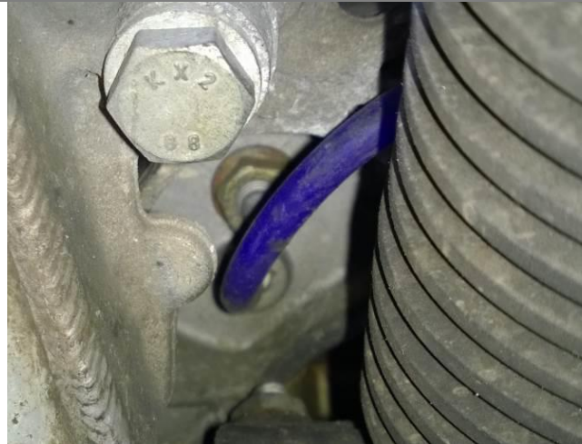
Abbildung 27: neuer Schlauch Motorlager Fahrerseite
