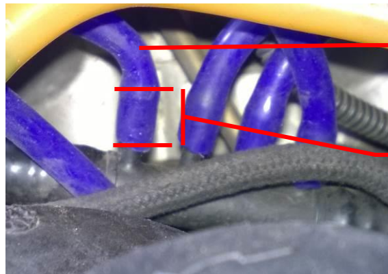
Abbildung 19: Schlauch richtig aufstecken
