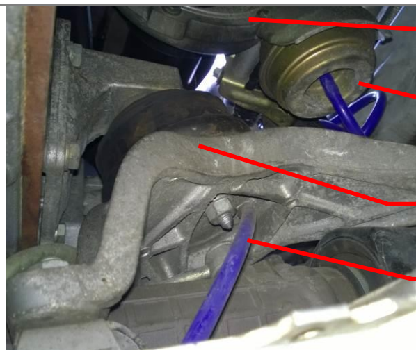
Abbildung 30: neuer Schlauch Motorlager Beifahrerseite
