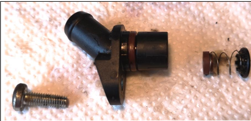
Abbildung 48: Aufbau Stutzen Vakuumpumpe
