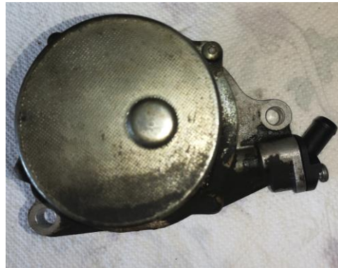
Abbildung 44: FL Vakuumpumpe MIT Rückschlagventil
