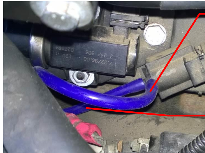
Abbildung 27: neuer Schlauch Druckwandler Motorlager
