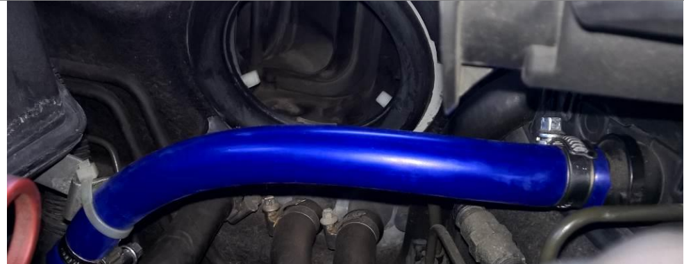
Abbildung 44: neuer Schlauch von der Hauptleitung zum Rückschlagventil
