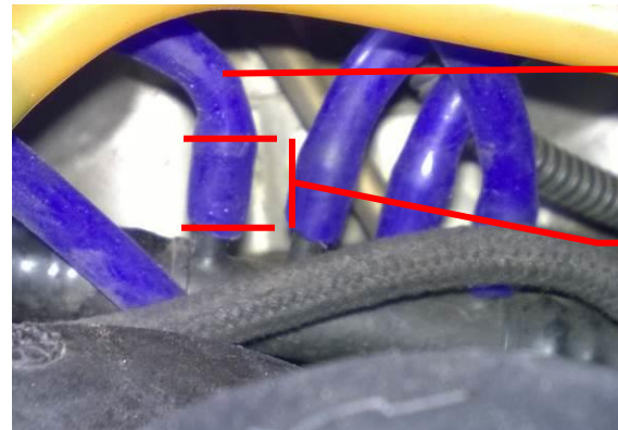
Abbildung 21: Schlauch richtig aufstecken
