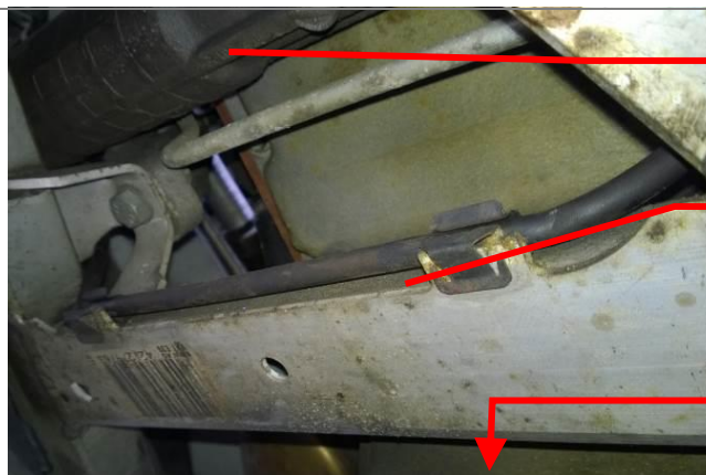
Abbildung 30: Schlauch zum Beifahrer Motorlager
