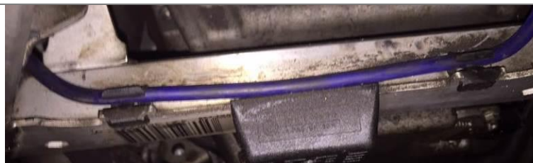
Abbildung 33: neuer Schlauch zum Motorlager
