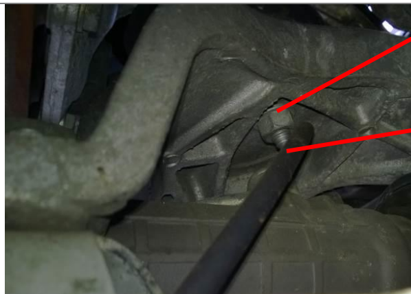
Abbildung 31: alter Schlauch Motorlager Beifahrerseite
