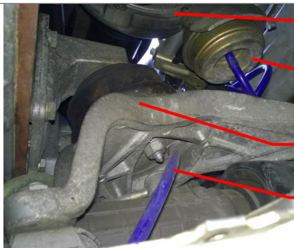
Abbildung 32: neuer Schlauch Motorlager Beifahrerseite
