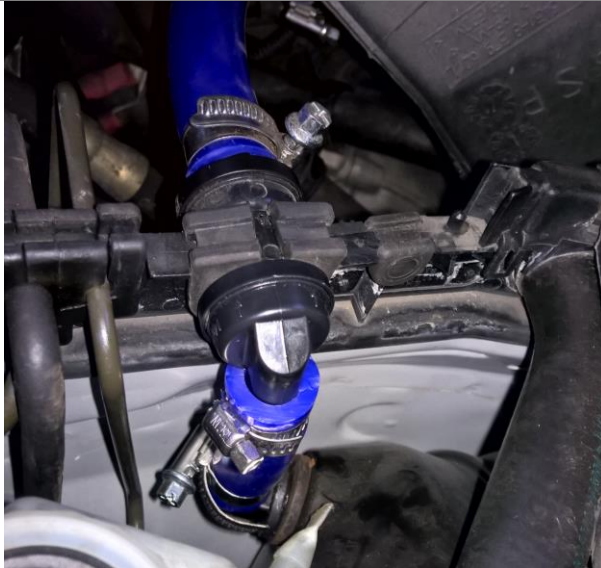
Abbildung 43: neuer Schlauch am Rückschlagventil und BKV
